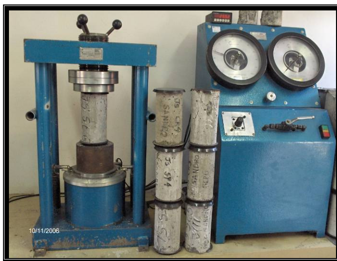
FIGURA 18 – Corpos de prova capeados com enxofre, prensa e cp's rompidos.
